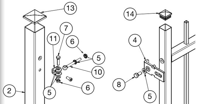
Die Torbandlasche (4) mithilfe der Unterlegscheibe (5) und der Sechskantschraube (8) am Torrahmen befestigen. Die Augenschraube (10) mitsamt den Unterlegscheiben (5), den Sechskanmuttern (6) und der Sechskantschraube (7) an den Scharnierpfosten anbringen.
