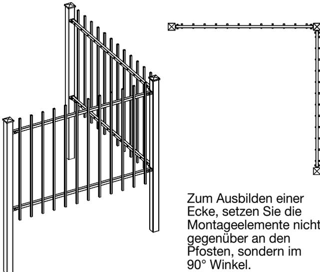
Zum Ausbilden einer Ecke, setzen Sie die Montageelemente nicht gegenüber an den Pfosten, sondern im 90° Winkel.
